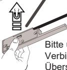
Bitte überprüfen Sie ob der Verbinde, ohne Überstand, in die Schiene passt
