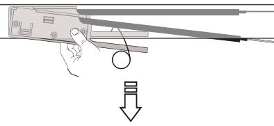
Verwenden Sie den Haken, um das Ende der Anspeisung einzuhaken, und ziehen Sie die Anspeisung dann mit den Händen heraus.
